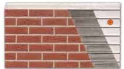
Система облицовки фасада по утеплителю с направляющими (KombiTherm), наиболее простой и быстрый монтаж.
